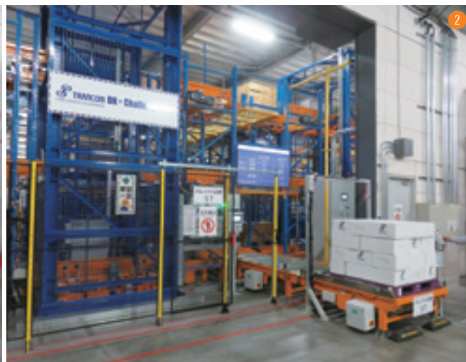
① フォークでステーションにパレットを下ろす ② コンベヤで自動倉庫に移動 ③ 垂直搬送機で保管フロアへ
