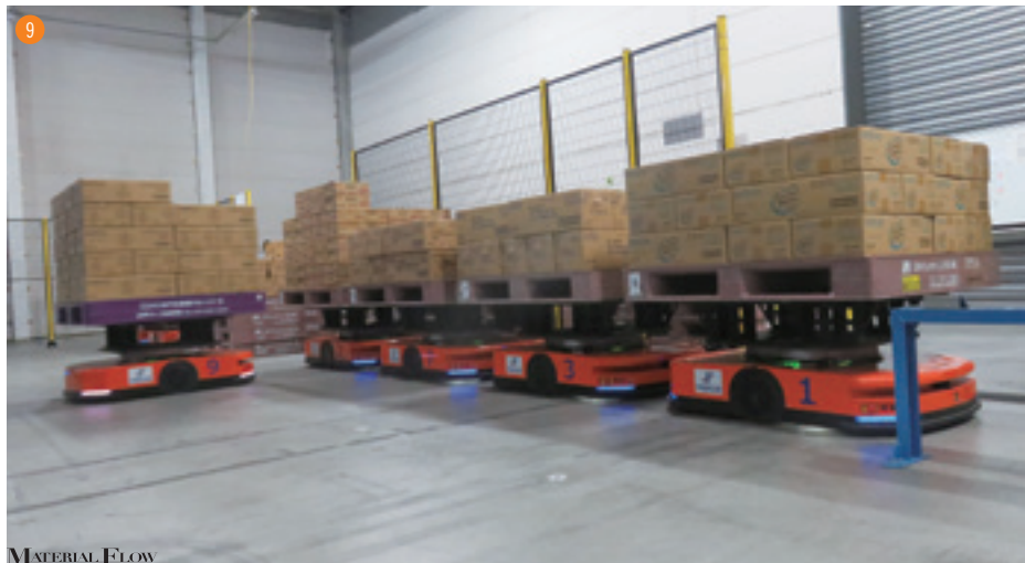
⑧ パレットを載せてAGVが移動 ⑨ デパレステーションに整列 ⑩ クイックトロン社製AGV M100
