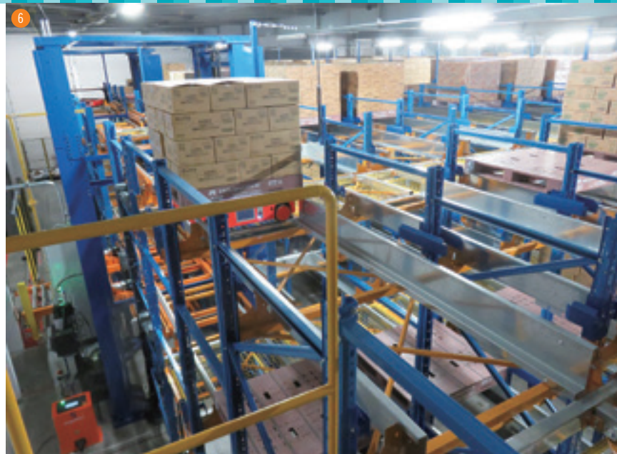
⑥ 垂直搬送機までRGVがパレットを運び ⑦ AGVの待つ1階へ降りる
