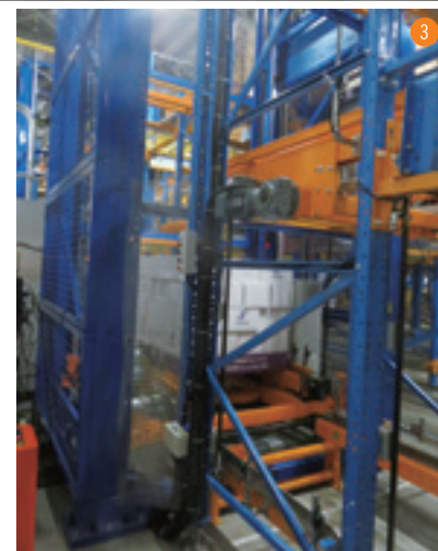
① フォークでステーションにパレットを下ろす ② コンベヤで自動倉庫に移動 ③ 垂直搬送機で保管フロアへ
