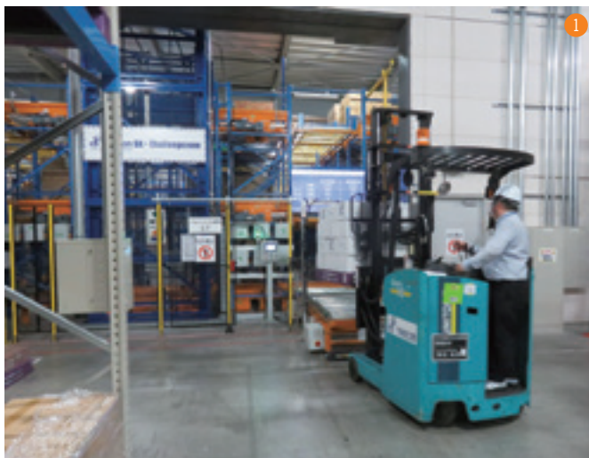
① フォークでステーションにパレットを下ろす ② コンベヤで自動倉庫に移動 ③ 垂直搬送機で保管フロアへ
