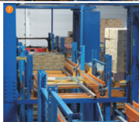
⑥ 垂直搬送機までRGVがパレットを運び ⑦ AGVの待つ1階へ降りる
