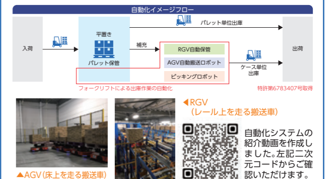
▲AGV（床上を走る搬送車） ▲RGV（レール上を走る搬送車）
