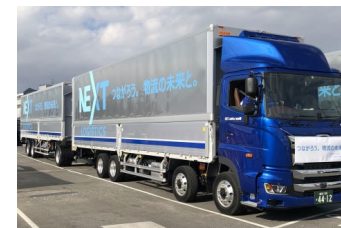
▲日野自動車開発の 全長25m級ダブル連結トラック
